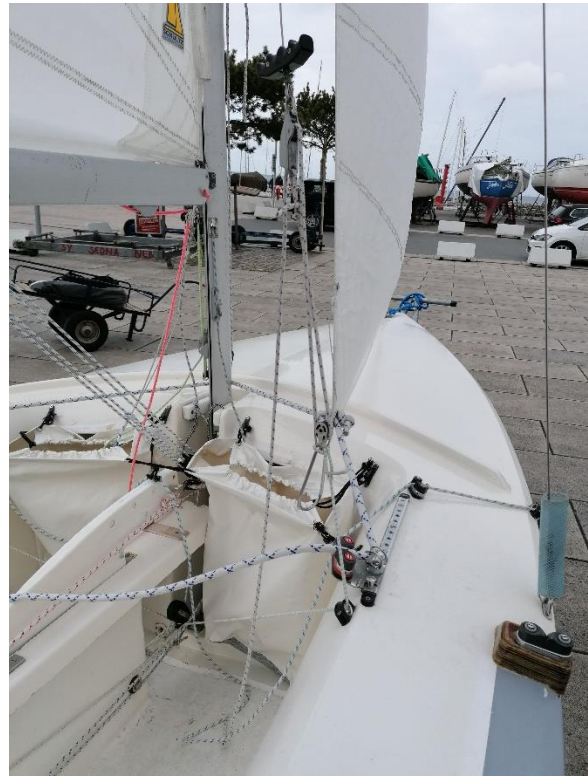
Die Luvschot ist dichtgezogen und zieht die Fock somit weiter ins Boot.
